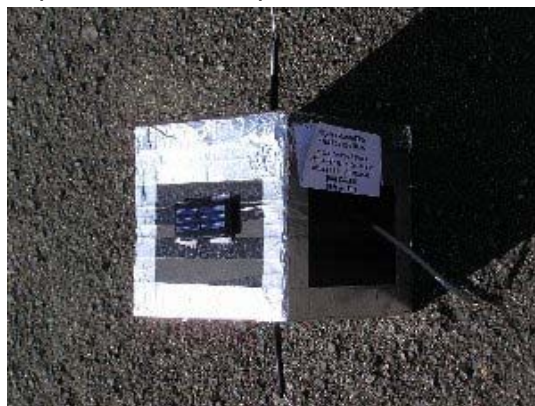
Detalle de uno de los microsatélites. Contiene cámara, timer y sensores de temperatura interna y externa y presión barométrica.
